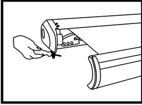
1. Manualmente extender el toldo, usando la manivela o un destornillador. Es necesario que esté proyectado totalmente.
