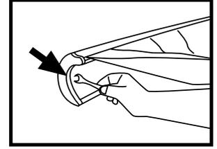
4. Desatornillar el perno de la tapa de la barra frontal, localizado en medio de la tapa.
