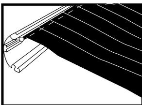
13. Deslizar la lona por la barra frontal y hacerlo juntamente con el número 12.
