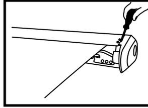
2. Desatornillar los dos pernos del lado derecho del cofre.
