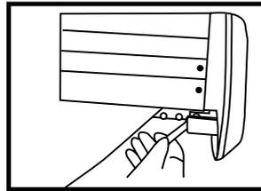
6. Desatornillar el tornillo que sostiene la tapa derecha. Tener en cuenta que el tornillo no se retira totalmente, simplemente se afloja.
