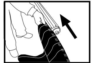
12. Deslizar la lona por el riel del rodillo juntamente con el número 13.
